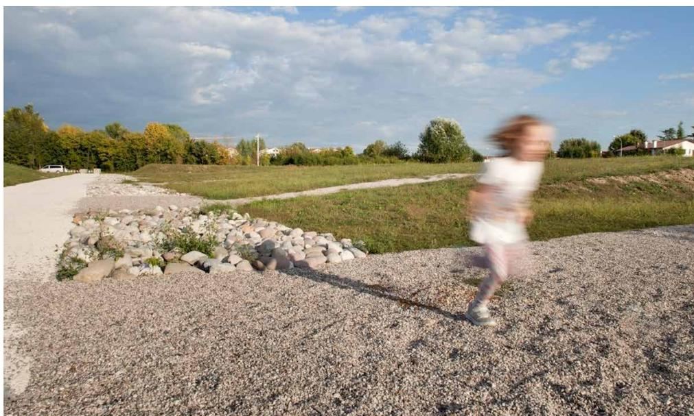
La ghiaia di fiume di diverse pezzature caratterizza e guida i percorsi, consentendo il drenaggio e la canalizzazione dell'acqua piovana
