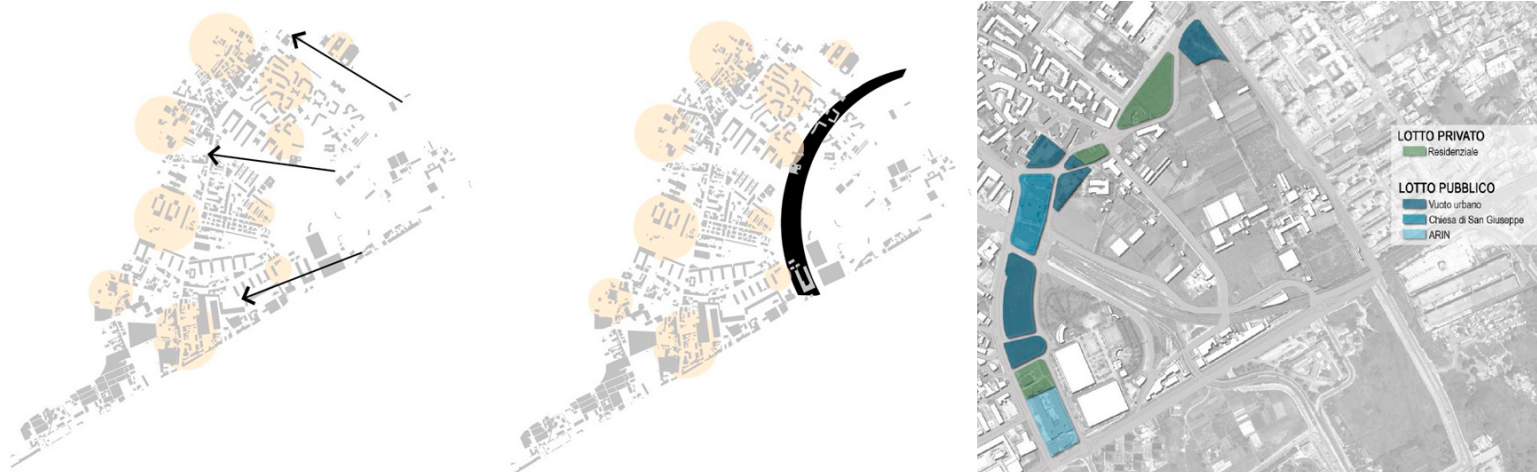
Figura 1 – Schema dei percorsi dell'acque e delle aree inondabili (a sinistra); schematizzazione della fascia "filtrante" a monte del centro abitato (al centro); localizzazione dell'area di intervento (a destra)
