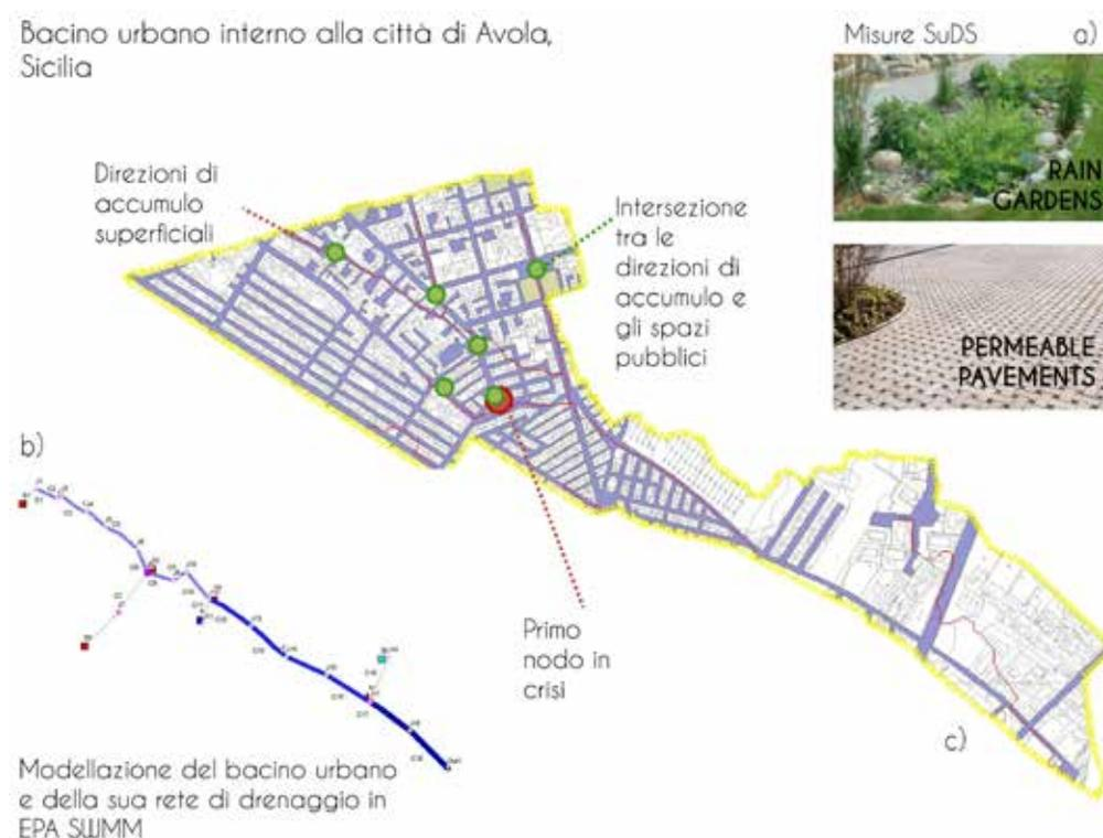
Figura 1 - a) Misure SuDS adottate nello scenario di post-implementation; b) Simulazione del bacino urbano nello scenario di pre-implementation; c) criteri di allocazione spaziale delle misure SuDS
