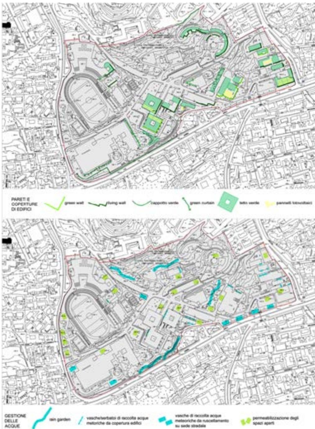
Figura 1- Azioni di adattamento sulle pareti e coperture degli edifici (sopra) ed azioni relative alla gestione delle acque meteoriche (sotto) all'interno della Città Universitaria di Catania
