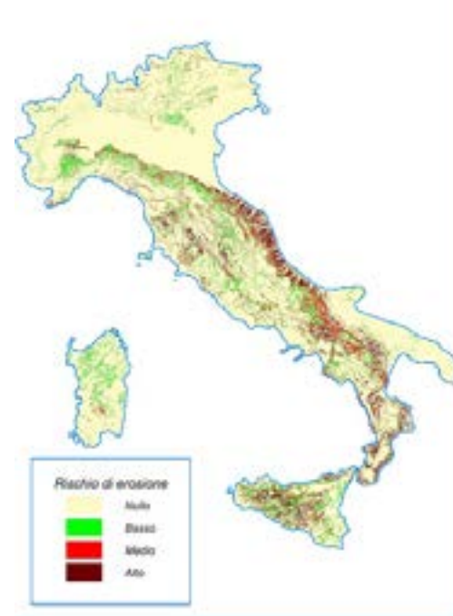
Figura 5 - Rischio di erosione Fonte: ISPRA, 2006 Nota: la mappa è ottenuta incrociando la pluviometria, la pendenza del suolo, la copertura vegetale e la litologia
